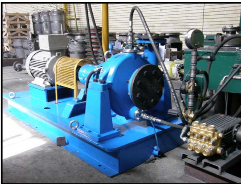
توضیحات: عکس فوق پمپ را حال تست هیدرواستاتیکی نهایی قبل از ارسال نشان می دهد.
